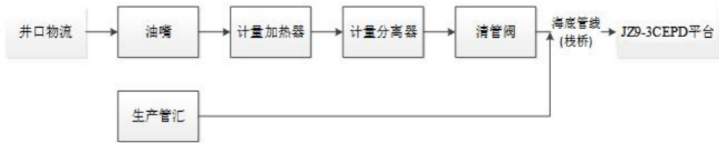
图 2.2 锦州 9-3 油田各平台井口物流处理工艺
